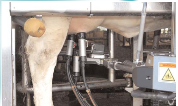
Roboterarm beim Anstecken der Zitzenbecher
