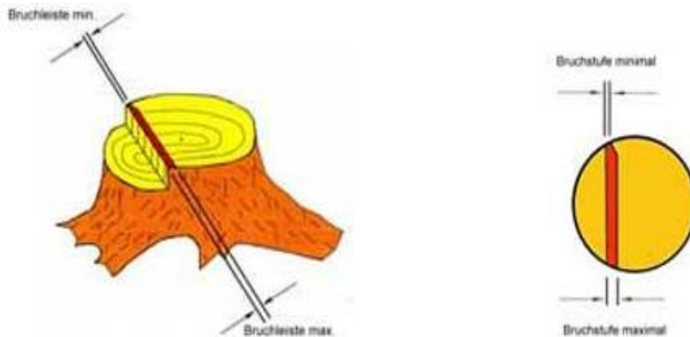
Abbildung 9 - Breite der Bruchleiste 3
