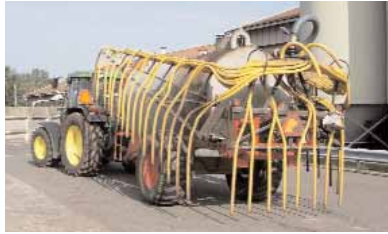
Bodennahe Gülleausbringung mit Schleppschräufen in Schweden
