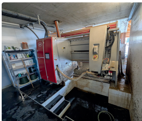
Ein generalüberholter Melkroboter melkt seit einem Jahr sehr zuverlässig
