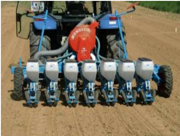
Einzelkornsaat mit 35 bzw. 70 cm Reihenweite
