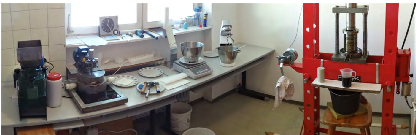
Abbildung 12: Die Versuchspresse (von links): Mahlwerk, Röstpfanne mit Rührwerk auf Induktionsfeld, Waage, Mixer zum Einrühren von Salz und Wasser, Presse mit dem Presstock
