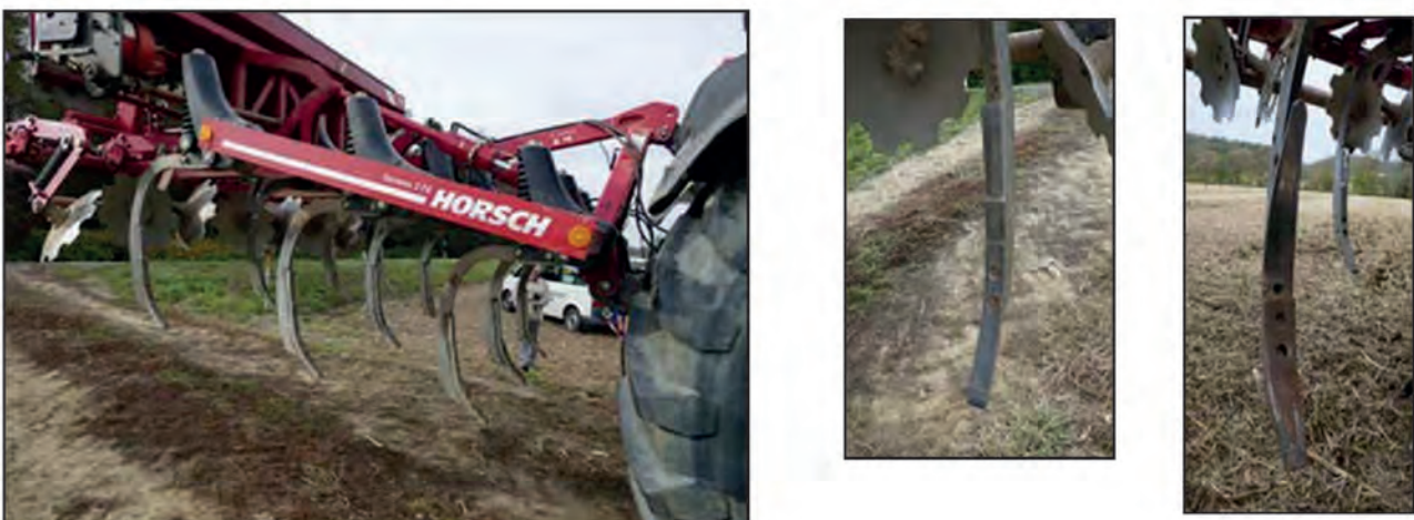
Grubber Horsch, 3-balkig, 10 Meißelschare (links) bzw. 10 Wendelschare (rechts)
