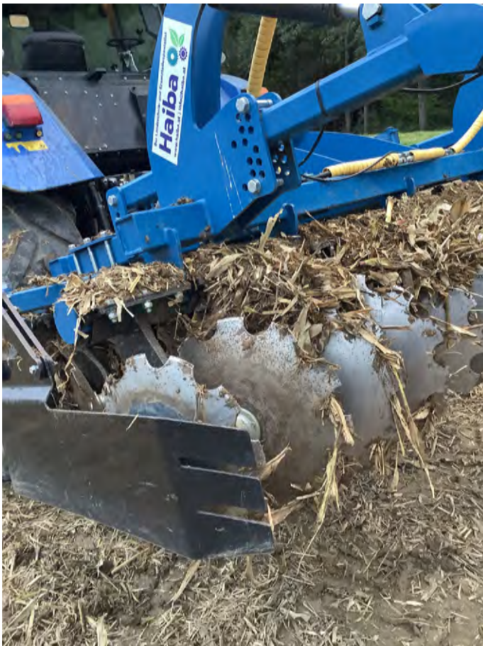
Abbildungen 5 und 6: Einsatz der Scheibenegge
