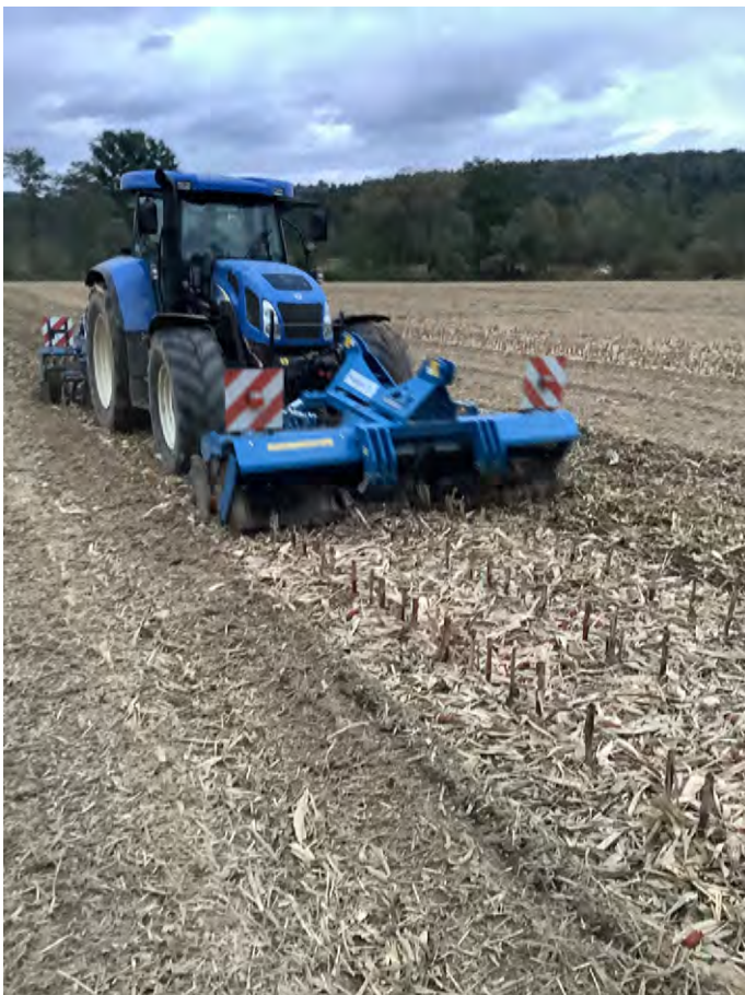
Abbildungen 7 und 8: Einsatz von Messerwalze und Scheibenegge bei der Strohbehandlung
