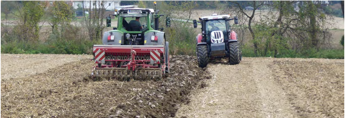
Abbildung 12 (oben): Bodenbearbeitung mit 4-Schar-Pflug und 3-balkigem Grubber Abbildungen 13 bis 18 (unten): die einzelnen Varianten nach der Bearbeitung am 15.10.2021
