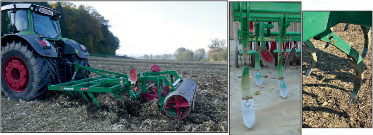
Grubber Regent 4-balkig; 15 Wendelschare (links) bzw. 15 Meißelschare (rechts)
