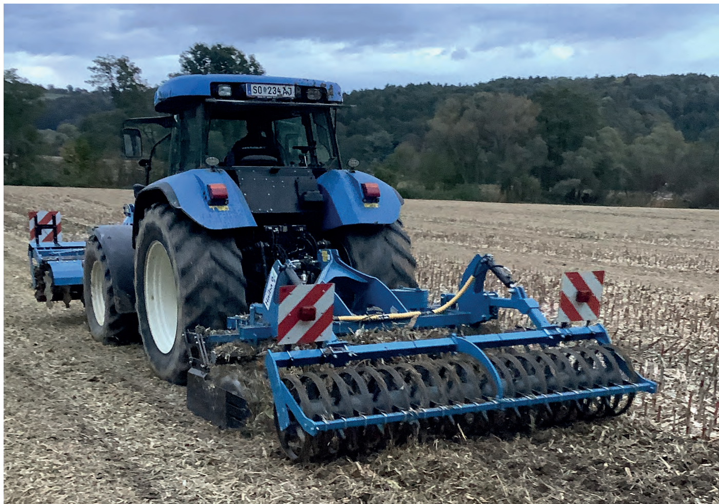
Abbildung 14: Kombination Messerwalze und Scheibenegge
