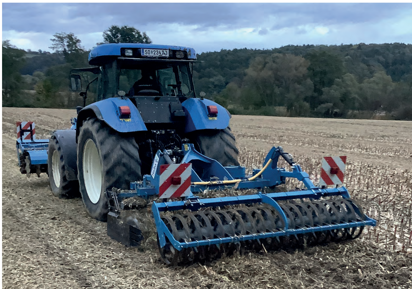
Abbildung 14: Kombination Messerwalze und Scheibenegge
